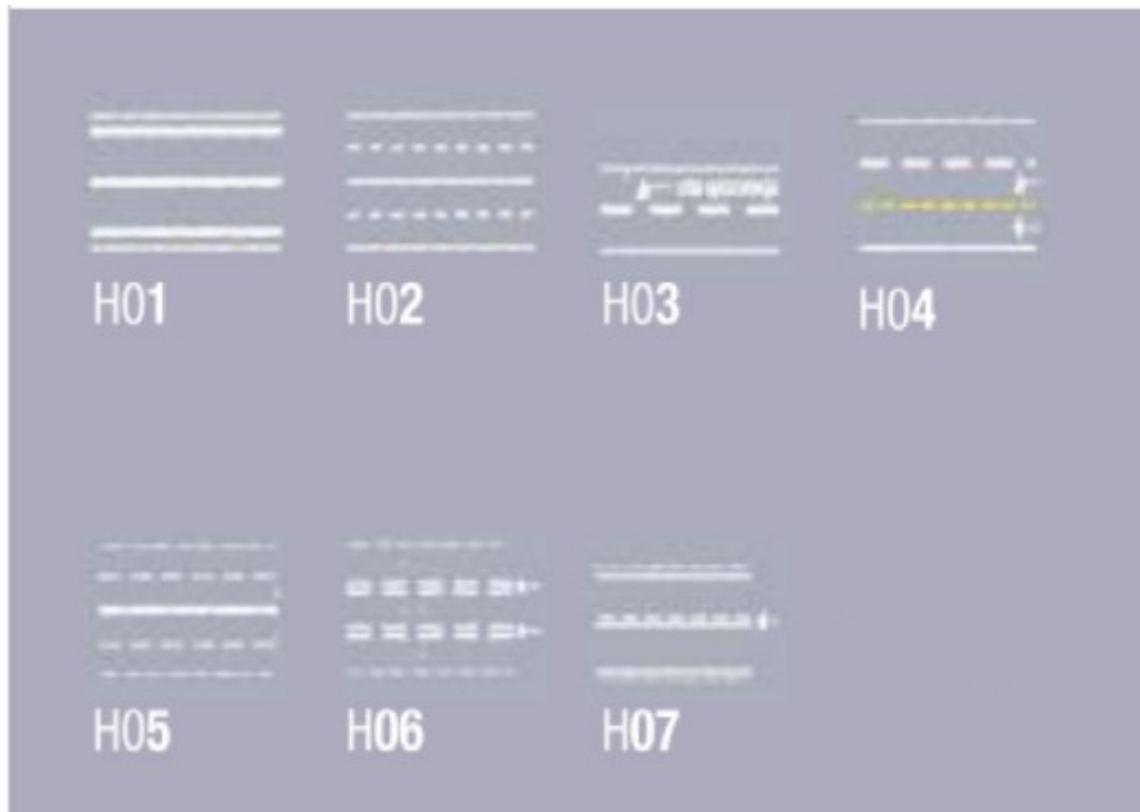
Slika 6. Primjer uzdužnih oznaka na kolniku
