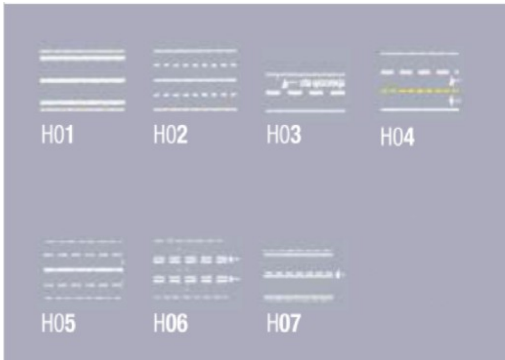
Slika 6. Primjer uzdužnih oznaka na kolniku
