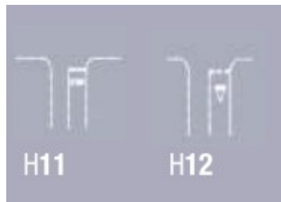
Slika 7: Isprekidane i pune crte zaustavljanja
