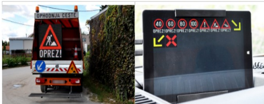
Slika 18. Led promjenjivi svjetlosni znak i upravljačka jedinica
