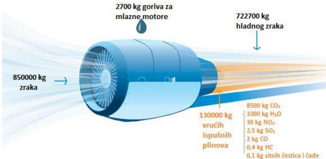
Slika 3. Proizvodi izgaranja zrakoplovnega mlaznog motora, [10]
