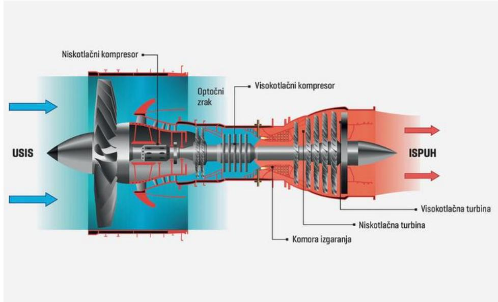
Slika 2. Shematski prikaz zrakoplovnog optočnog mlaznog motora, [8]
