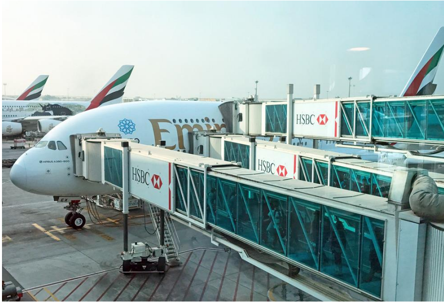
Slika 22. Tri aviomosta spojena na zrakoplov Airbus A380 Izvor: [35]
