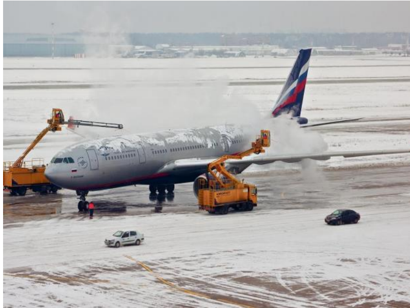
Slika 12. Stajanka za odleđivanje i zaštitu zrakoplova protiv zaleđivanja Izvor: [23]
