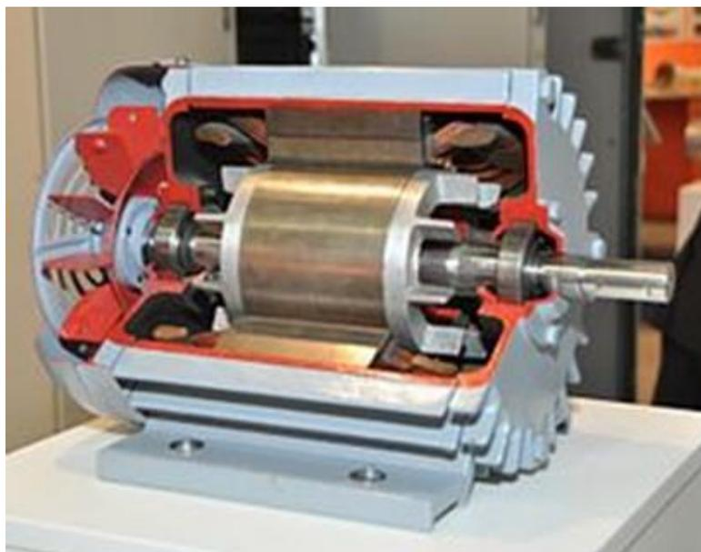
Slika 11. Presjek elektromotora
