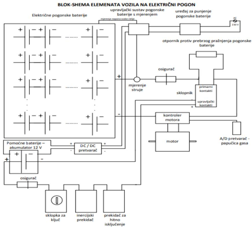
Slika 6. Blok shema elemenata vozila na električni pogon
