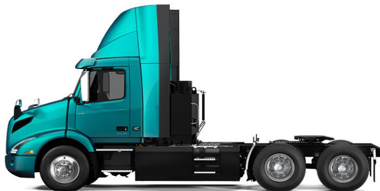
Slika 30. Volvo VNR tegljač s pogonom 6x4
