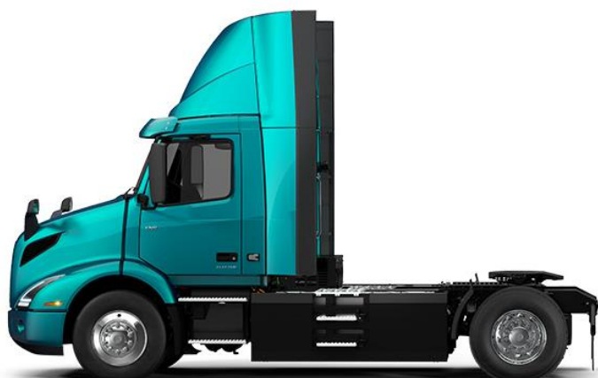
Slika 28. VNR tegljač s pogonom 4x2
