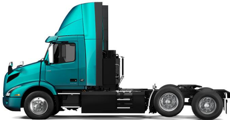
Slika 29. Volvo VNR tegljač s pogonom 6x2
