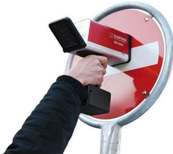
Slika 22. Retroreflektrometar Zehntner ZRS 6060
