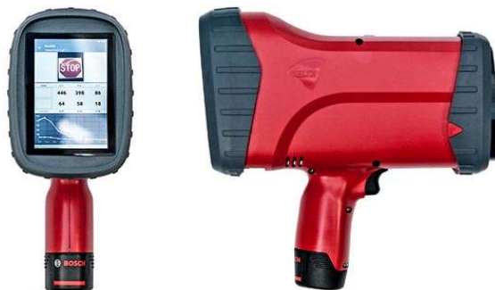
Slika 23. Retroreflektrometar RetroSign GRX
