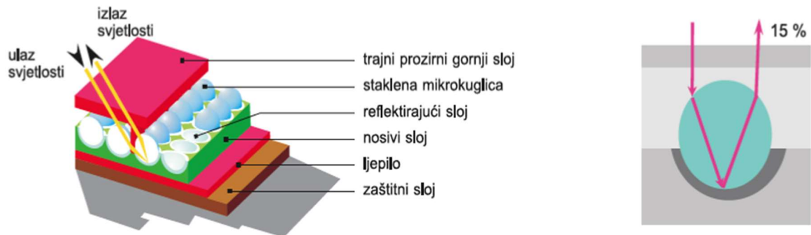
Slika 18. Retroreflektirajući materijal klase II
