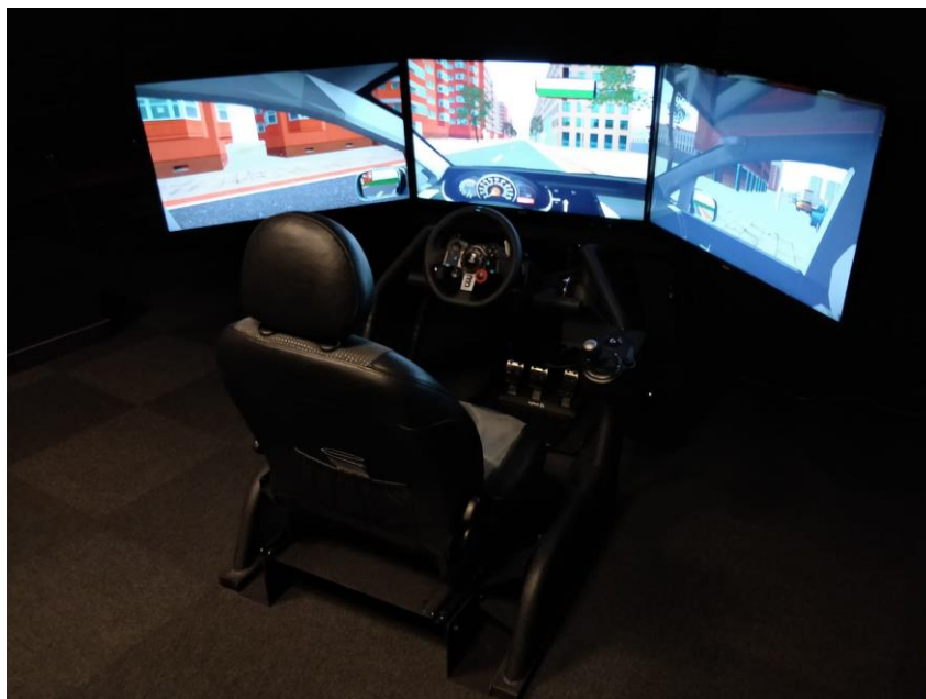
Slika 15. Simulator vožnje korišten u istraživanju
