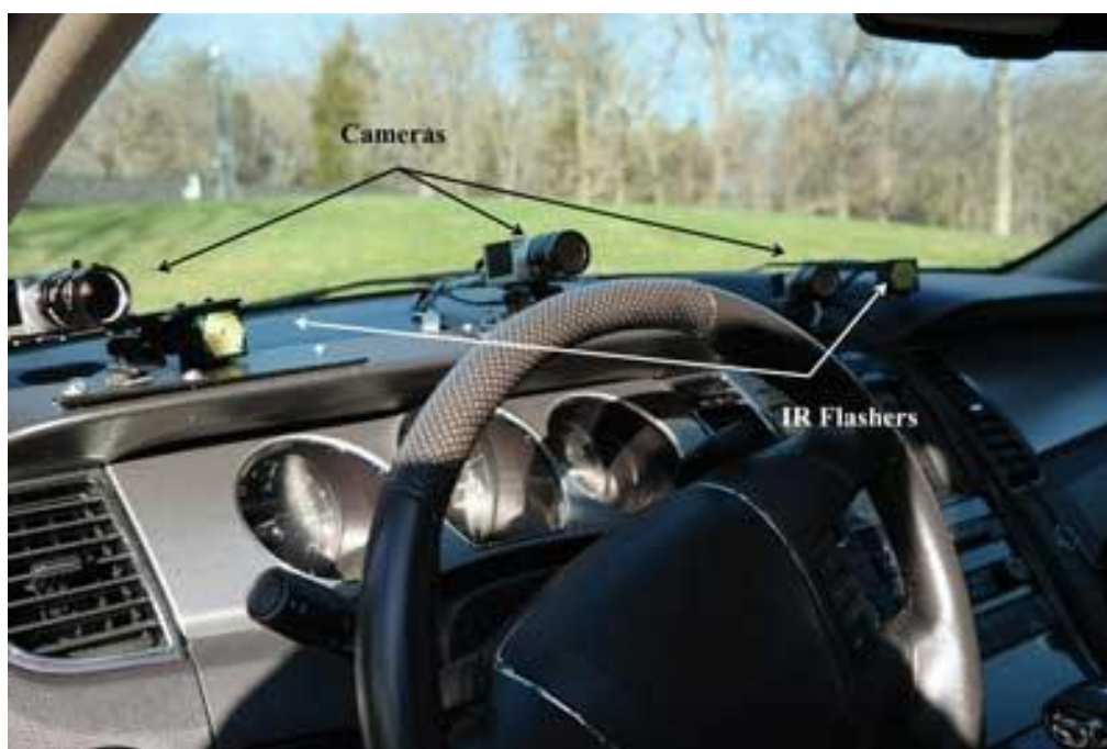
Slika 10. Sustav s tri kamere za praćenje pokreta oka i video kamerom za snimanje prometnice Izvor: [53]
