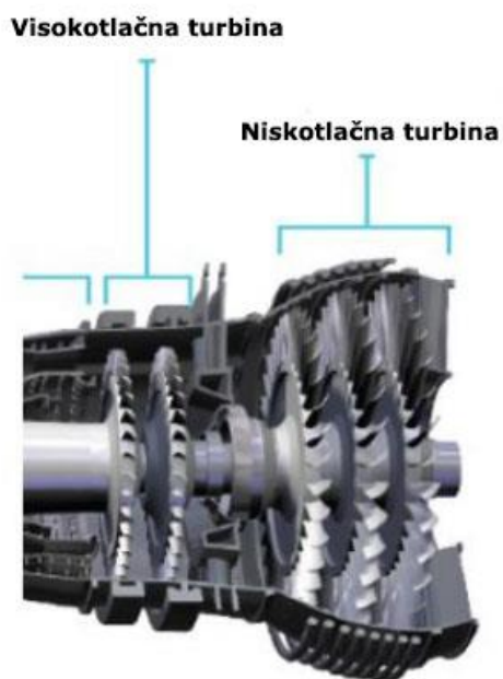
Slika 16. Turbina motora PW 1100G-JM, [24]
