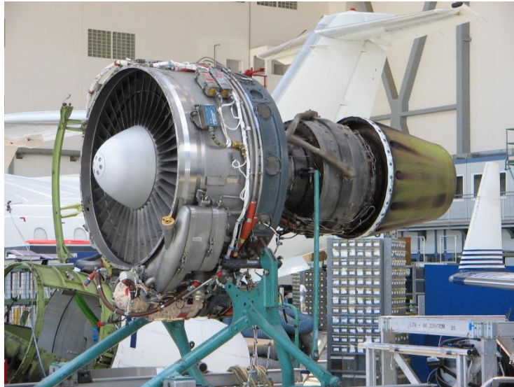
Slika 2. ALF 502 skinut sa Bombardier Challenger-600, [5]
