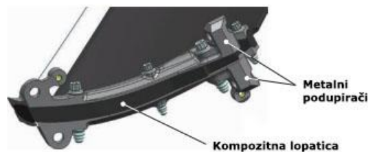
Slika 12. Struktura kompozitnih izlaznih vodilica ventilatora, [19]
