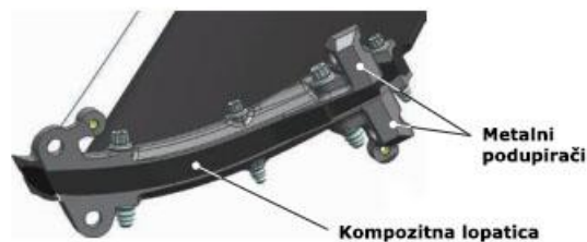
Slika 12. Struktura kompozitnih izlaznih vodilica ventilatora, [19]
