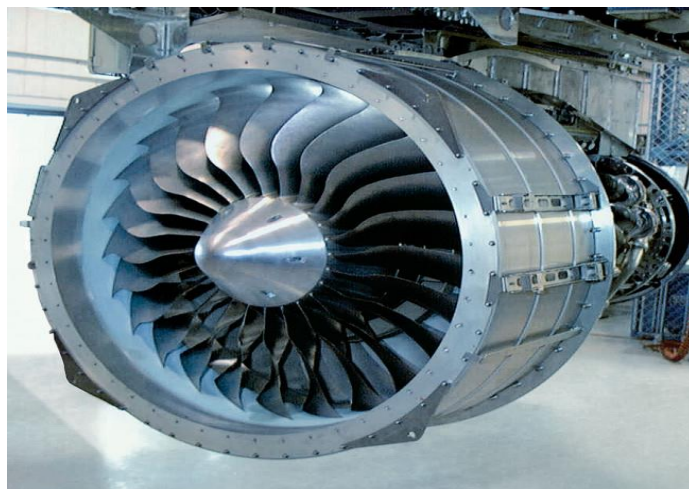
Slika 4. Prethodnik Pratt & Whitney GTF motora: ATFI, [8]
