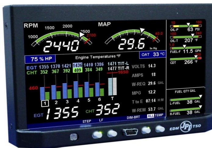
Slika 13. EDM 900 sustav za praćenje parametara motora, [21]
