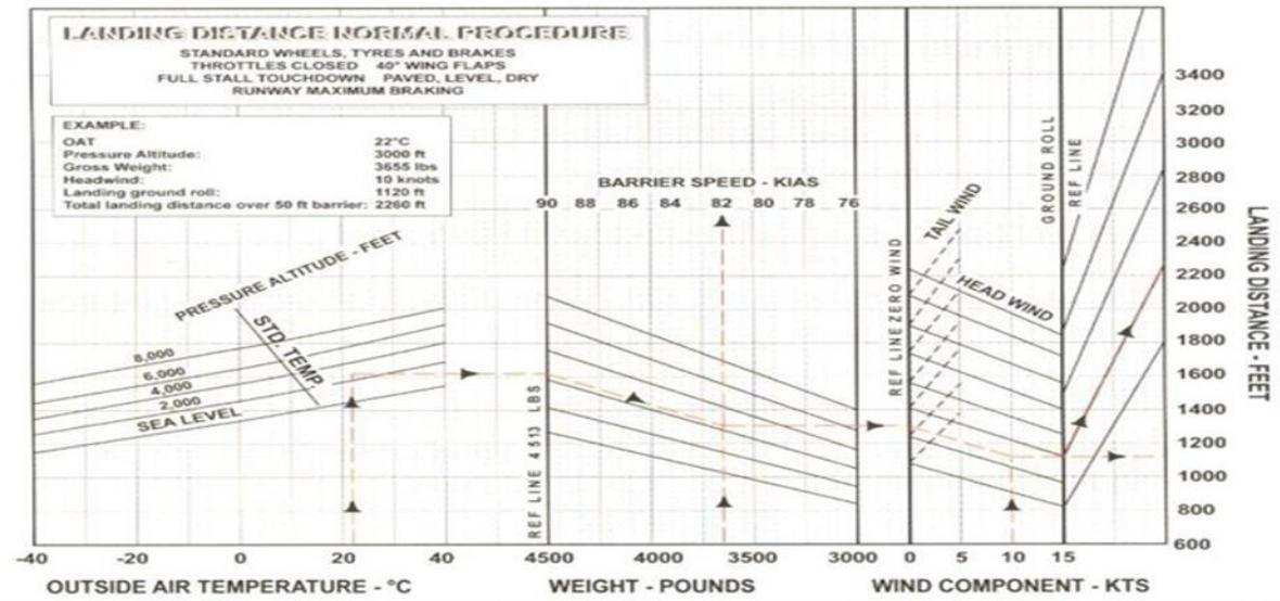
Slika 3. Način određivanja potrebne udaljenosti za slijetanje, [7]
