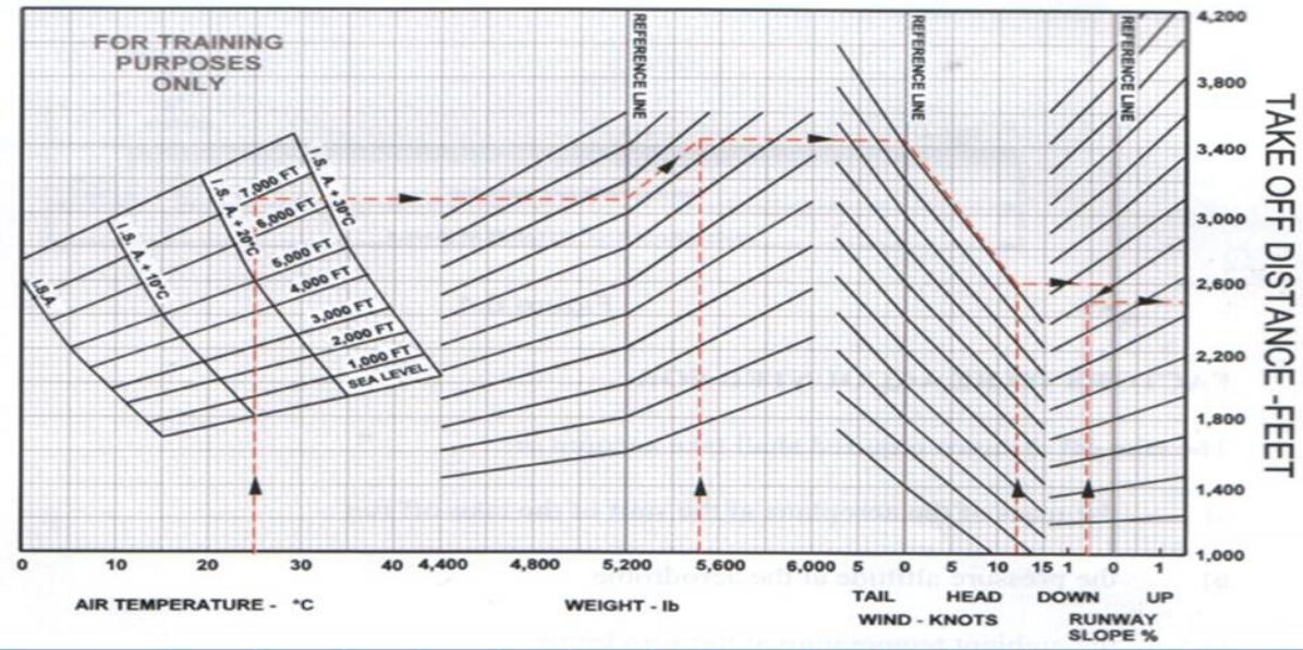
Slika 2. Način određivanja potrebne duljine za polijetanje, [6]
