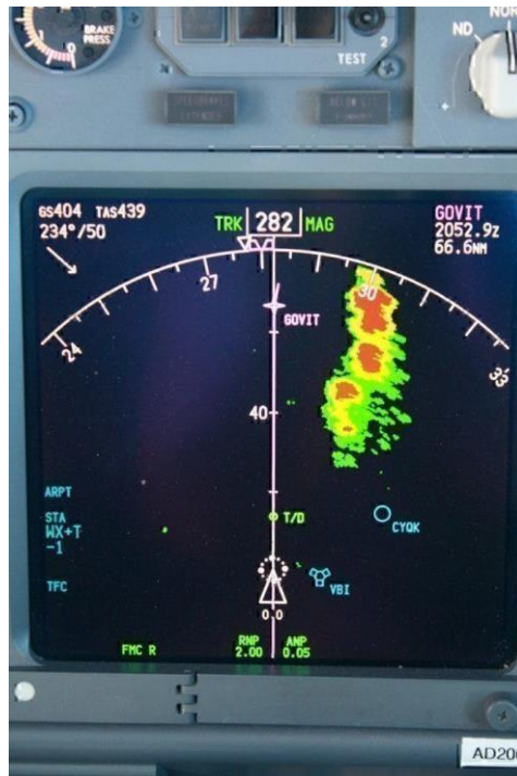
Slika 11 Meteorološki radarski sustav u zrakoplovu Boeing 737 [18]
