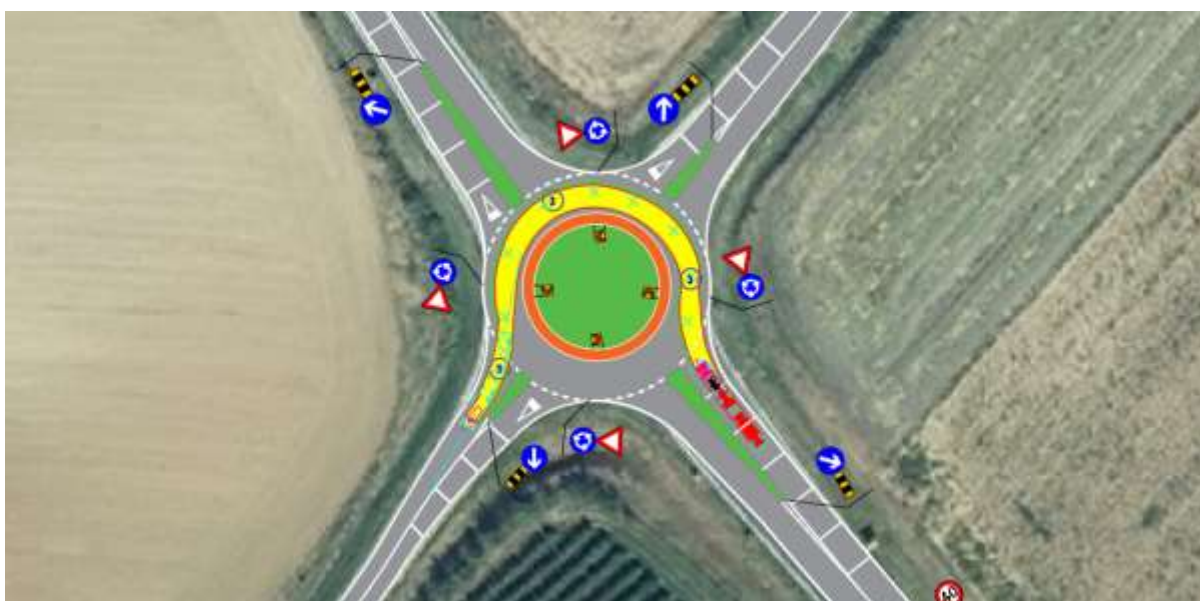
Slika 35. Prikaz proznosti vozila „Lastzug“ kroz raskrižje ulice biskupa Antuna Mandića i D7
