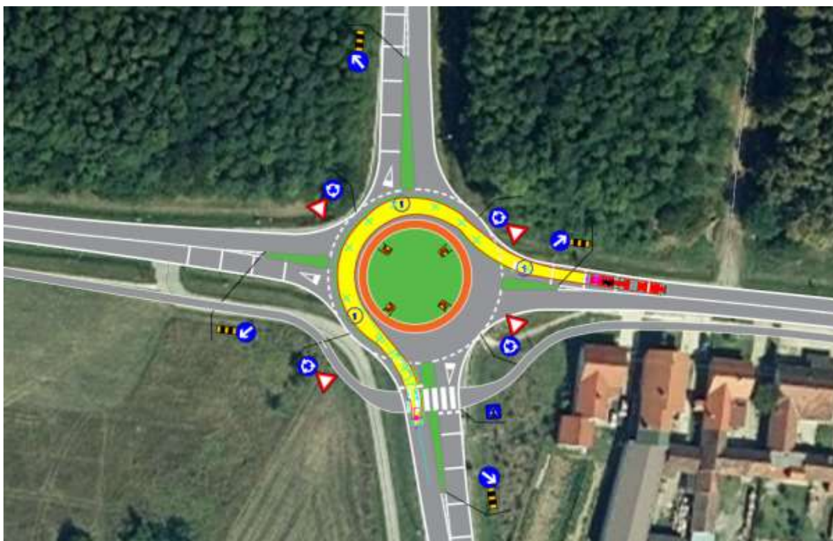
Slika 34. Prikaz proznosti vozila „Lastzug“ kroz raskrižje ulice Franjo Rački i D7
