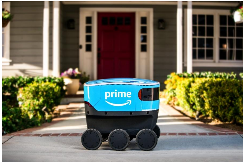
Slika 12. Scout robot za dostavu Izvor: [31]
