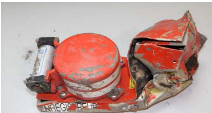
Slika 12. CVR uređaj nakon zrakoplovne nesreće na letu Germanwings 9525
