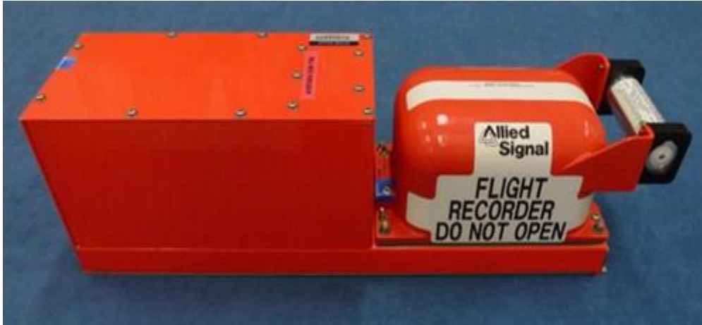
Slika 2. Uređaj za snimanje parametara leta zrakoplova
