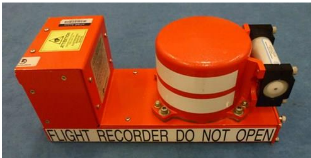
Slika 3. Uređaj za snimanje zvuka u kokpitu
