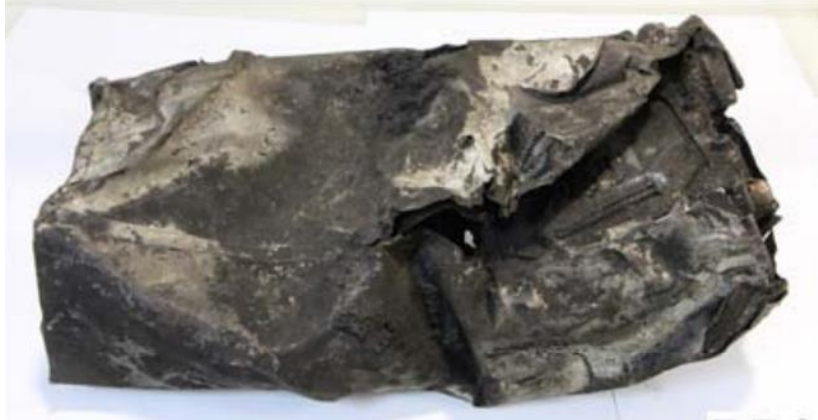
Slika 13. FDR uređaj nakon zrakoplovne nesreće na letu Germanwings 9525
