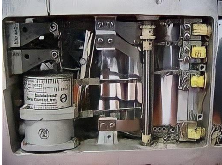
Slika 5. Uređaj za snimanje leta prve generacije
