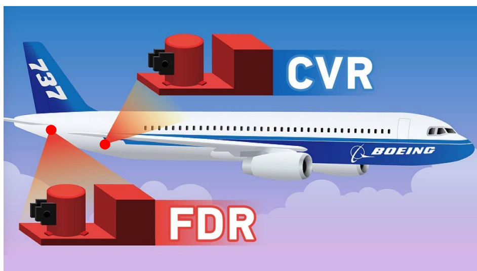
Slika 4. Lokacija FDR i CVR uređaja u zrakoplovu
