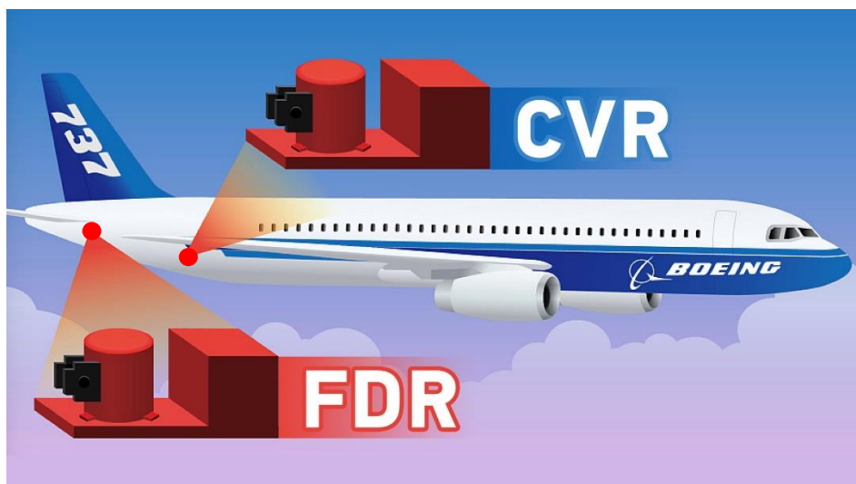
Slika 4. Lokacija FDR i CVR uređaja u zrakoplovu
