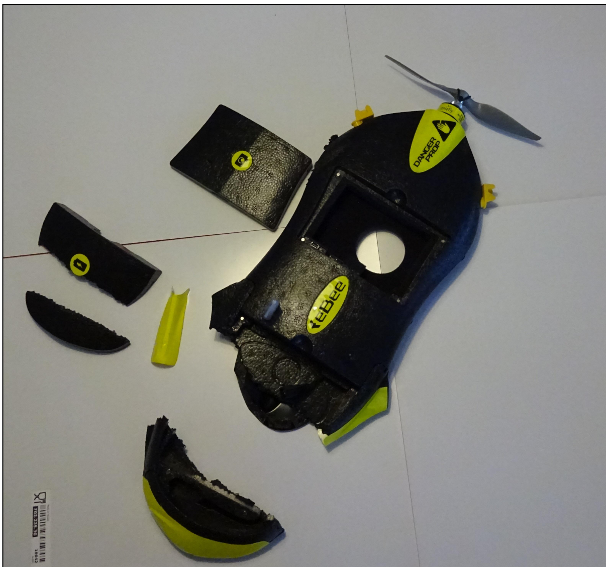
Slika 14. Fotografija komponenti trupa eBee-a nakon pada.
