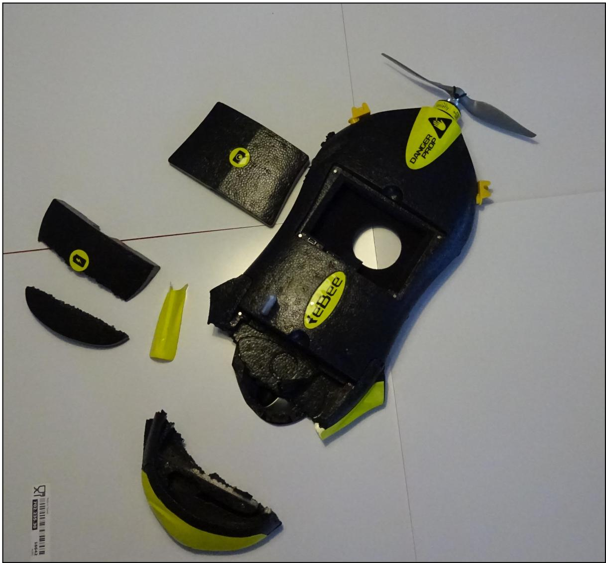
**Slika 14.** Fotografija komponenti trupa eBee-a nakon pada.
