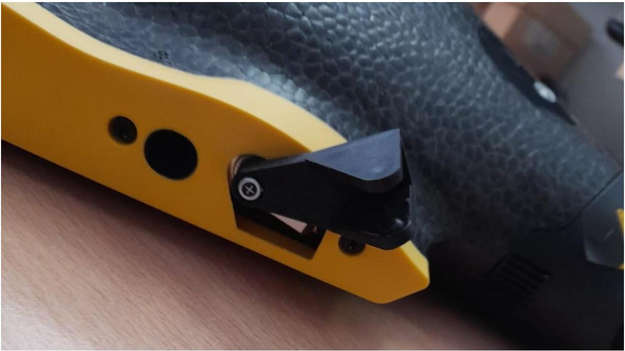
**Slika 6.** Servo mehanizam za upravljanje zakrilcima zrakoplova.
