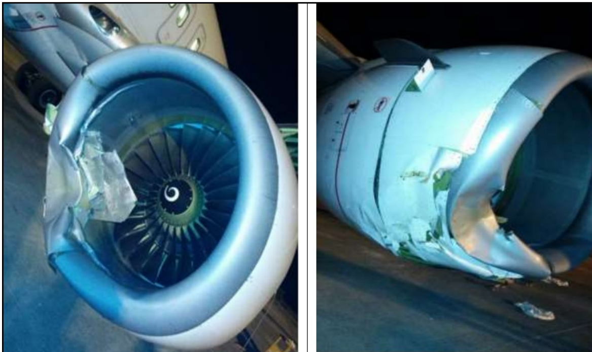
Slika 19. Oštećenje na lijevom motoru, [25]
