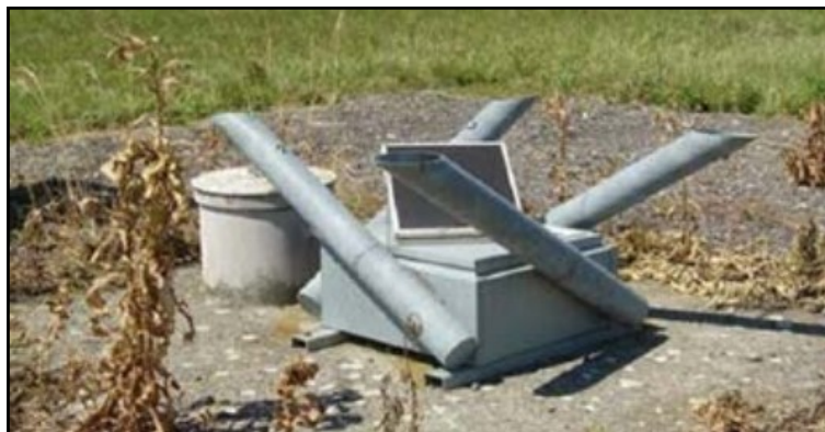
Slika 51. Podzemni stacionarni generator buke, [31]
