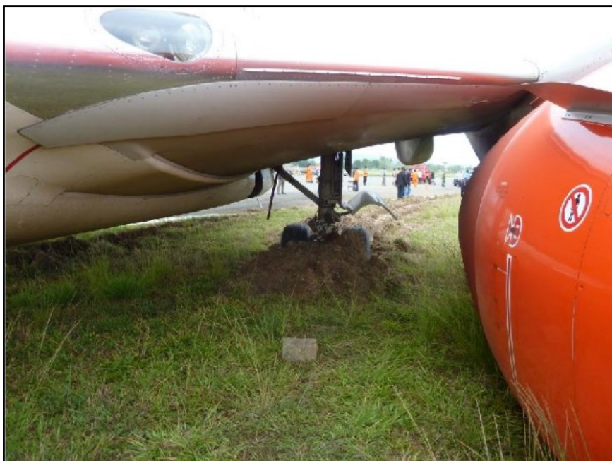
Slika 26. Kotači zrakoplova PK-LKH zarobljeni u zemlji, [28]
