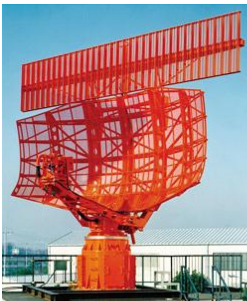
Slika 3. Kombinacija primarnog i sekundarnog nadzornog radara (zakrivljena donja antena je PSR, a ravna antena na vrhu je SSR), [23]
