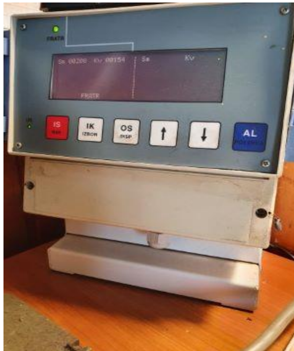
Slika 28. Uređaj za daljinski nadzor (ERP-6) ugrađen u prometnom uredu kolodvora Primorski Dolac
