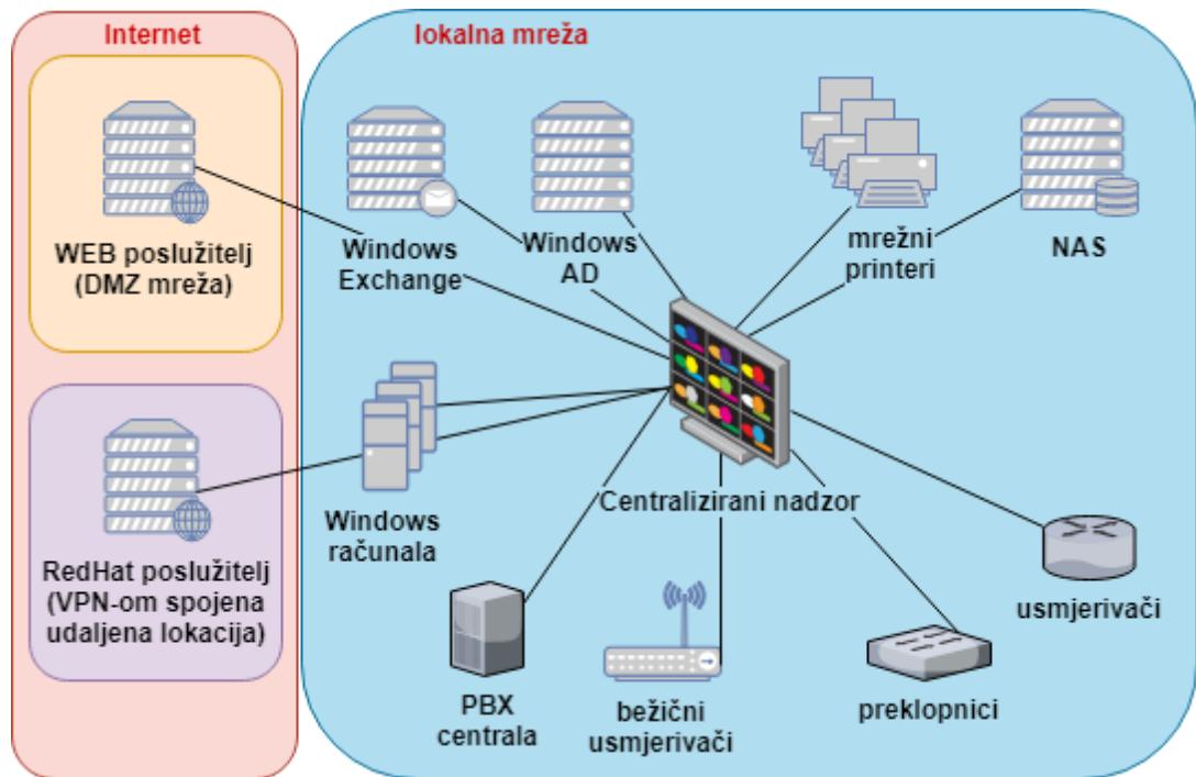
Slika 15: Primjer centralnog nadzora lokalnih i udaljenih mrežnih uređaja, [14]
