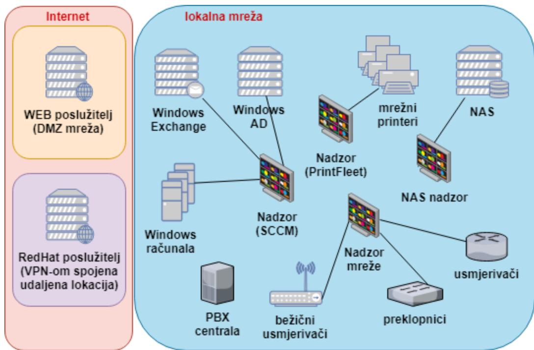
Slika 14. Primjer nadzora mrežnih uređaja bez unificiranog rješenja, [14]
