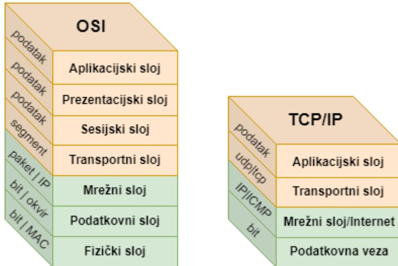
Slika 7. Usporedba OSI i TCP/IP referentnih modela, Izvor: [2], [3].
