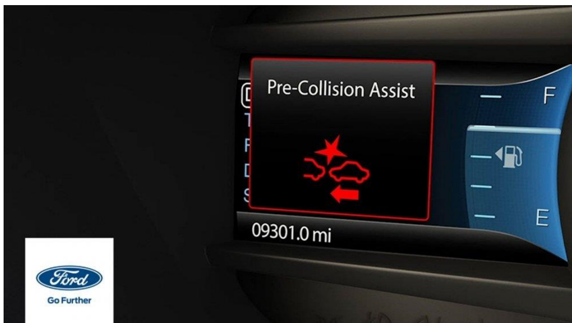
Slika 13. Sustav automatskog kočenja u slučaju opasnosti
