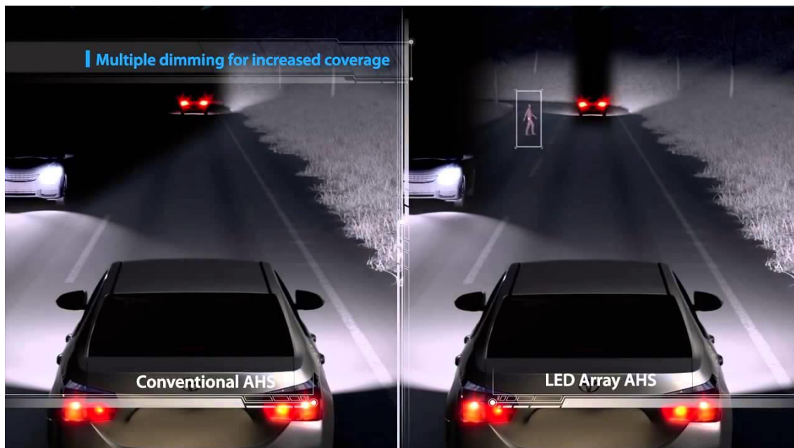
Slika 11. Sustav automatskog prebacivanja između dugih i kratkih svjetala
