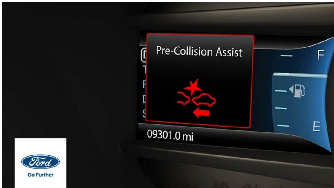
Slika 13. Sustav automatskog kočenja u slučaju opasnosti
