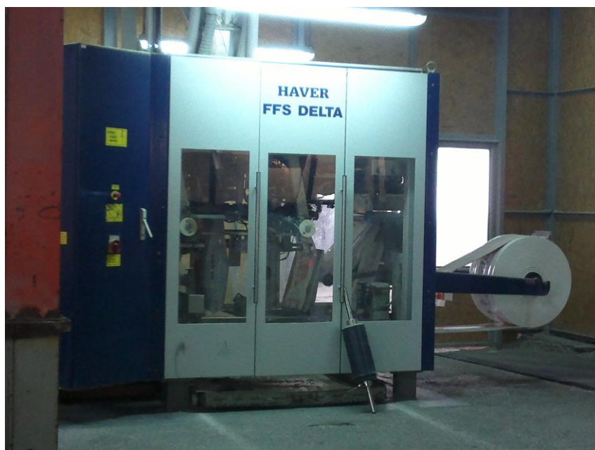
Slika 5. Stroj za automatsko pakiranje Haver & Boecker, serije FFS Delta
