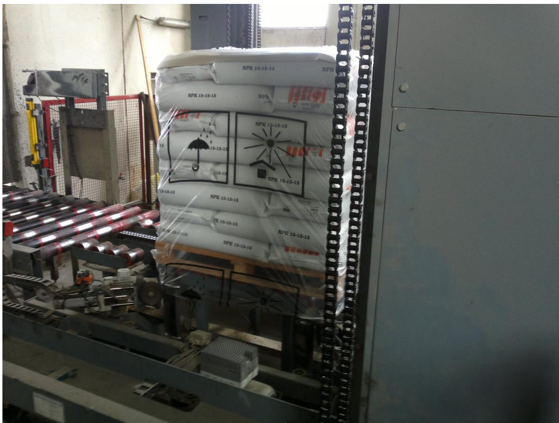
Slika 4. Navlačenje stretch folije na paletu
