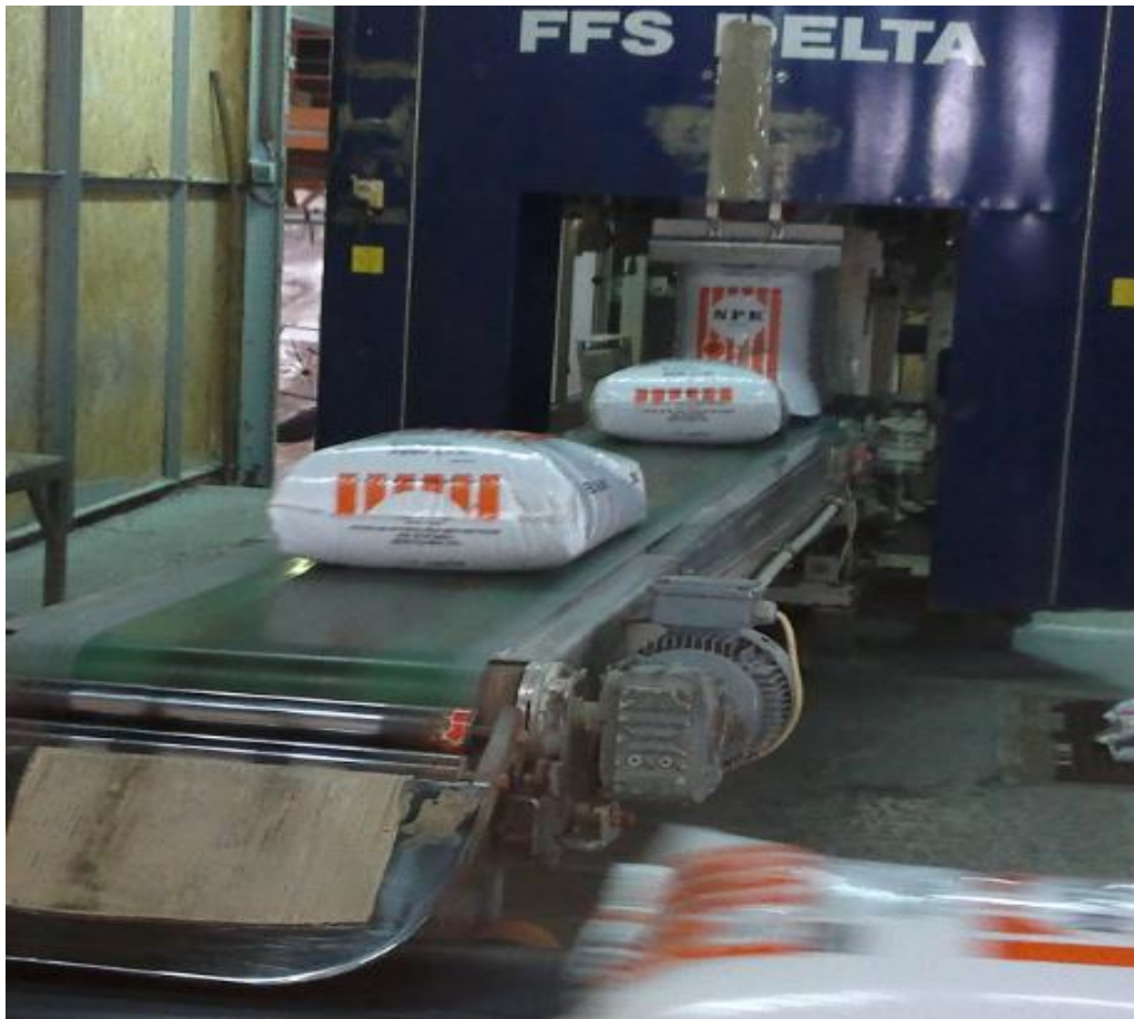
Slika 7. Izlaz gotove vreće iz stroja FFS Delta
