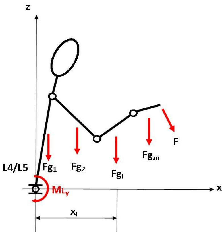
Slika 6.3. Dvodimenzionalni štapni model ispitanika u sagitalnoj ravnini
