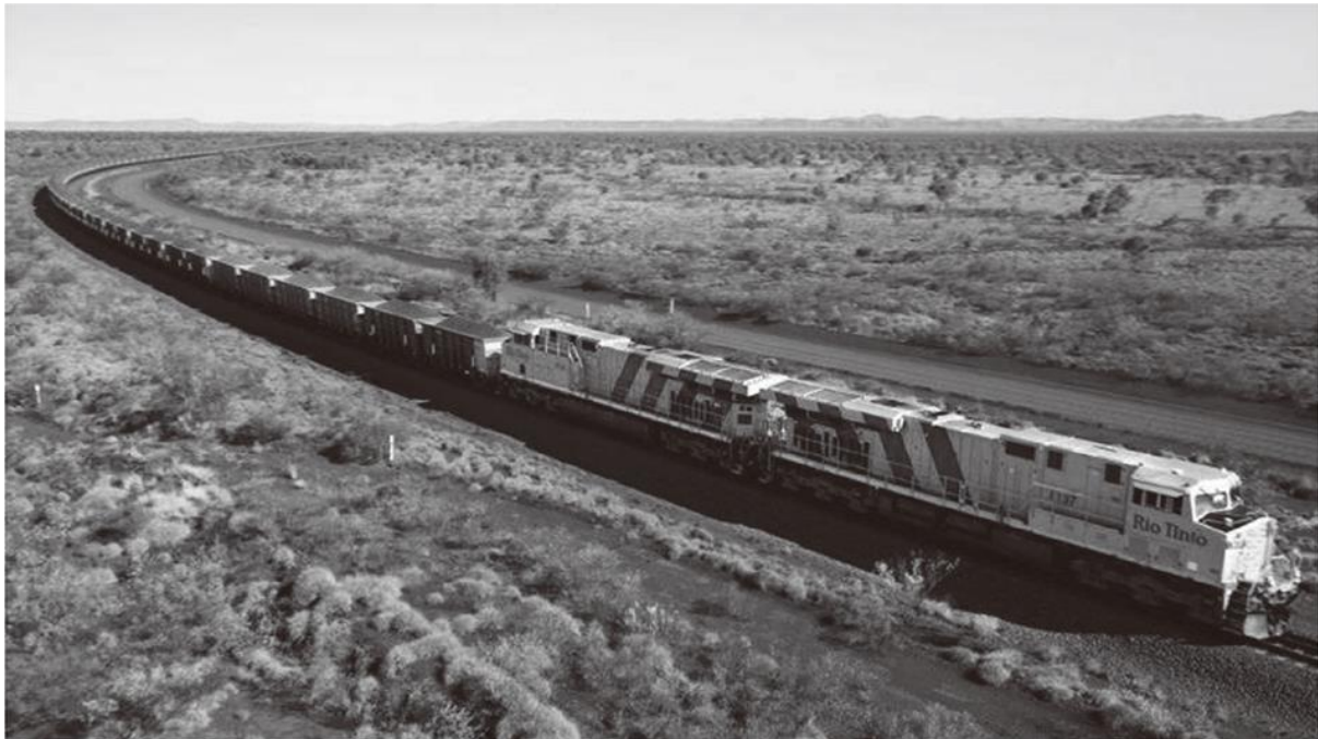
Slika 15. Autonomni vlak koji koristi AutoHaul sustav
