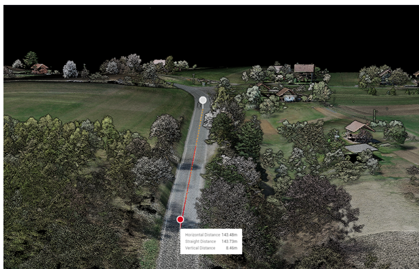
Slika 26. Mjerenje uzdužnog nagiba ceste na 3D modelu pomoću u softverskog alata
