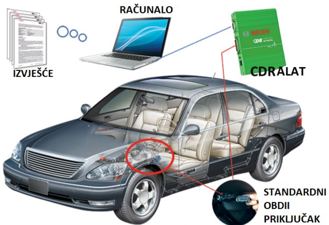
Slika 8. Shematski prikaz pozicije EDR uređaja
