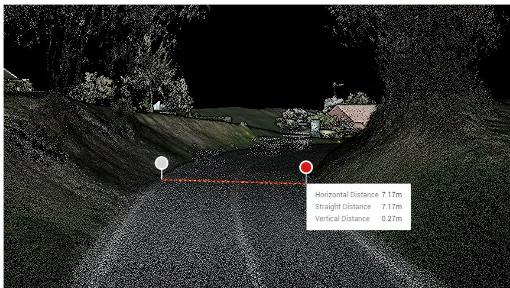
Slika 27. Mjerenje širine kolnika na 3D modelu pomoću u softverskog alata
