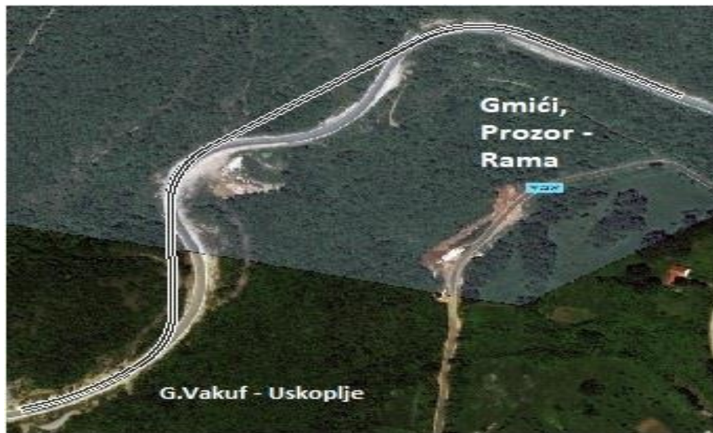
Slika 35. Idejno rješenje poboljšanja tlocrtnih elemenata dionice – Gmići
