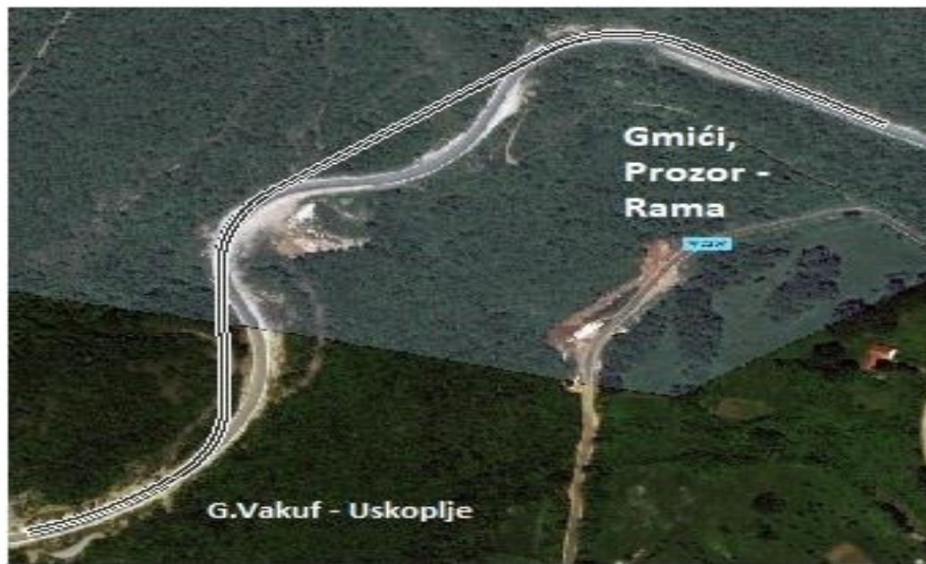
Slika 35. Idejno rješenje poboljšanja tlocrtnih elemenata dionice – Gmići
