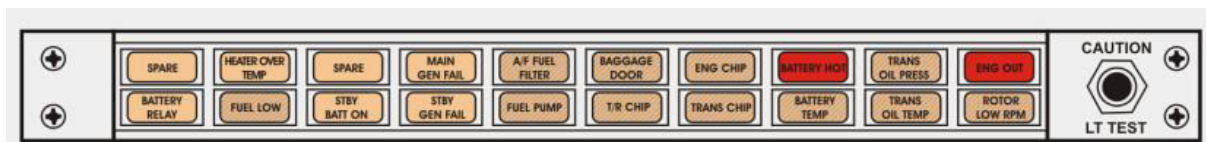
Slika 15. Panel s upozoravajućim svjetlima IFR inačice helikoptera [1]
