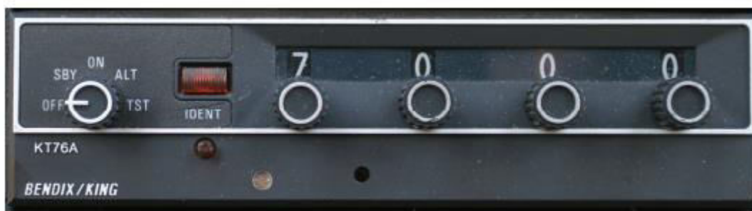
Slika 13. Upravljački panel primopredajnika KT 76A [1]
