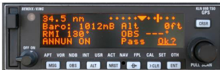
Slika 5. Upravljački panel prijavnika KLN 89B [1]
