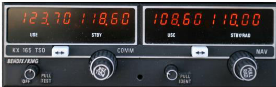
Slika 11. Upravljački panel primopredajnika KX 165 [1]
