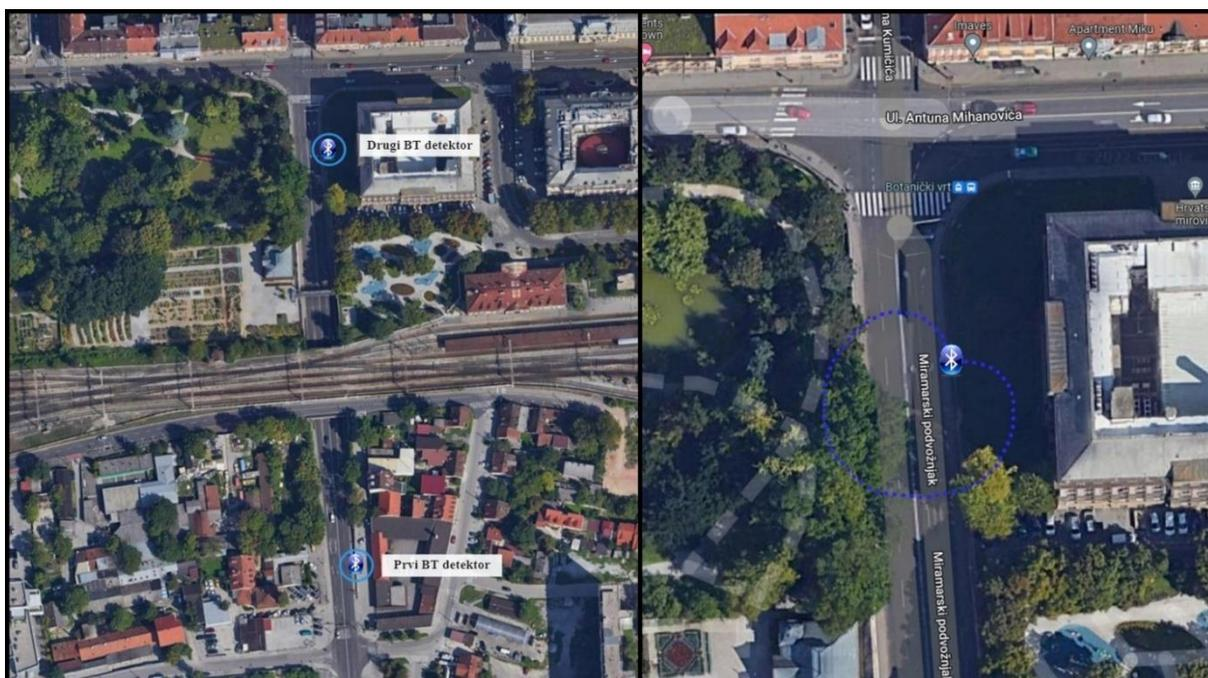
Slika 5. Lokacije BT detektora i oblik detekcijskog područja usmjerenog detektora
