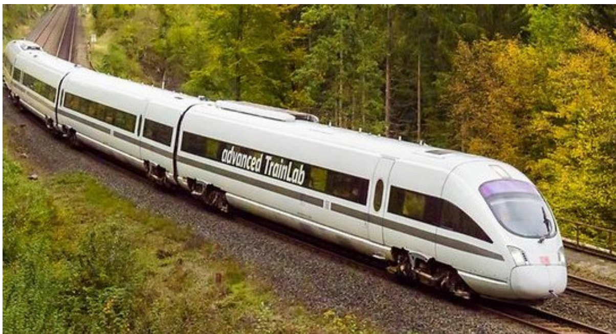
Slika 8. „Advanced TrainLab“- Deutsche Bahn istraživački vlak (ICE TD klase 605) s hibridnim dizel-električnim pogonom opremljen naprednim komunikacijskim i senzorskim sustavima [53].
