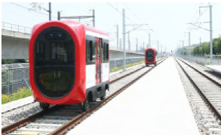
Slika 1. Testiranje 5G autonomnih željezničkih vozila na trasi „Osong Railway“ SK [32]
