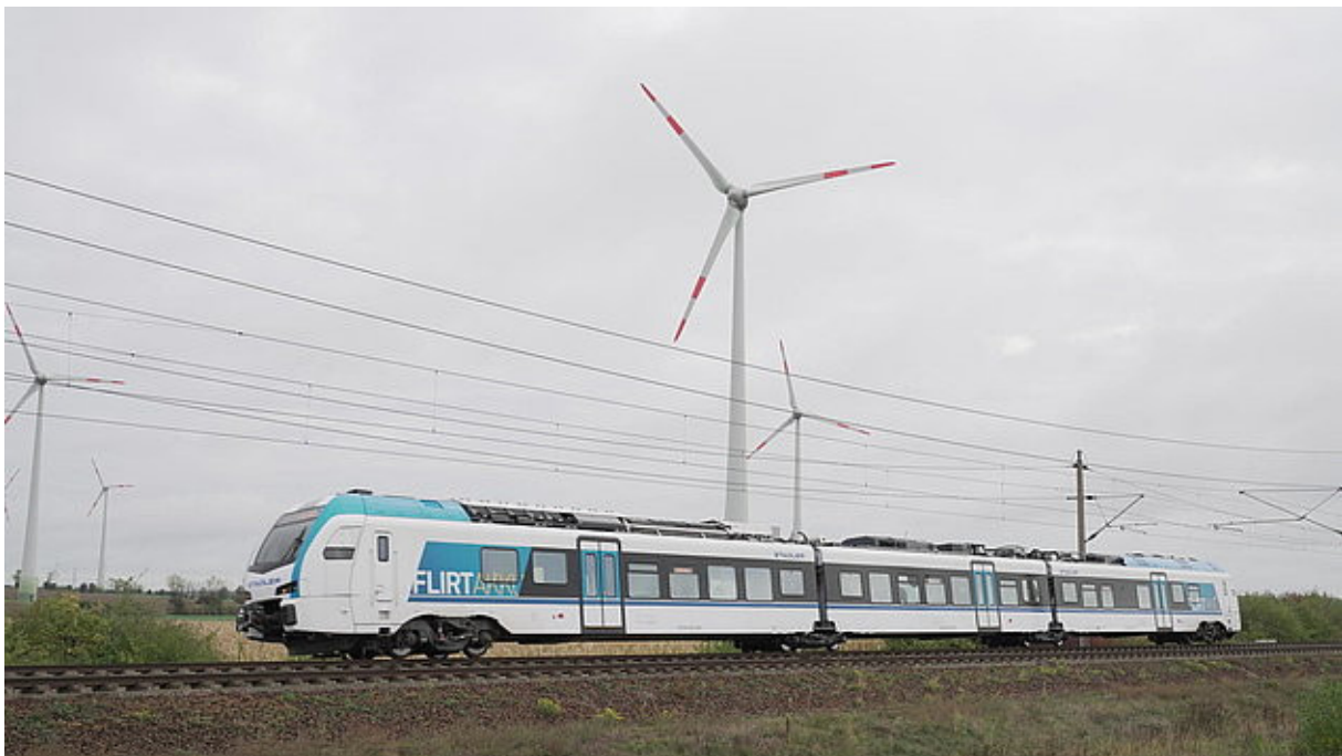
Slika 16. Stadler „FLIRT Akku“ vlak na baterijski pogon za željezničke rute bez emisije CO 2 [63]
