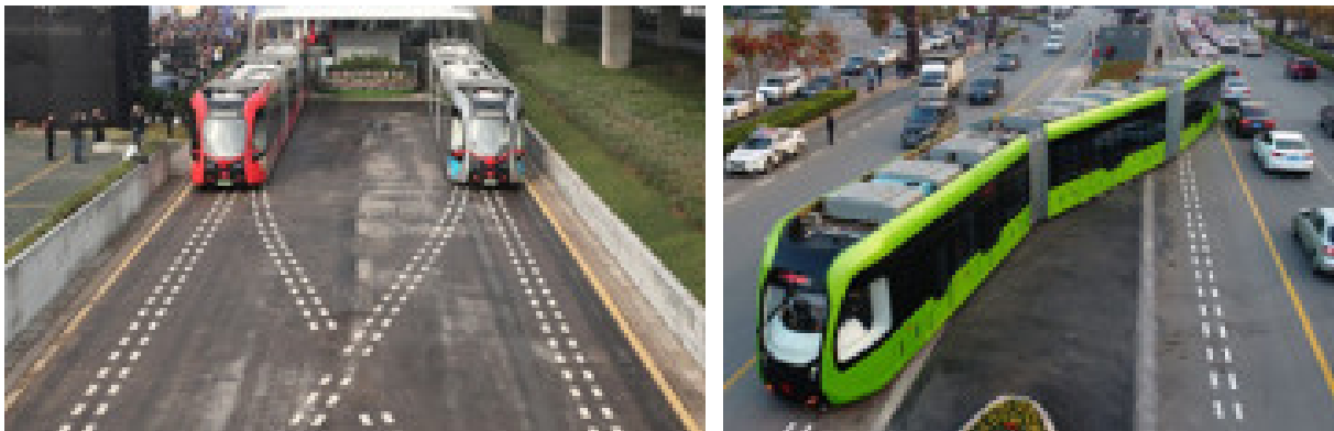
Slika 2. U gradu Zhuzhou prometuju autonomni vlakovi sa virtualnim tračnicama i senzorskom podrškom (engl. Autonomous Rail Rapid Transit - ART) [33]
