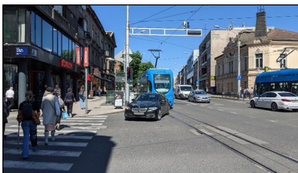
Slika 28. Kumulativni efekt faktora smetnji – stajališta, traka za desno skretanje, semaforiziranog raskrižja i usporednih pješaka kod stajališta Kvaternikov trg Izvor: autor
