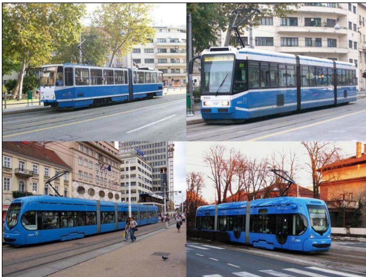
Slika 19. Tipovi tramvaja novijeg datuma: ČKD Tatra KT4 (gore lijevo), TMK 2100 (gore desno), TMK 2200 (dolje lijevo) i TMK 2300 (dolje desno)
