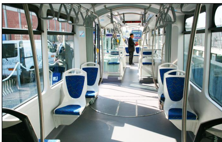
Slika 10. Široka i uska stajaća površina tramvaja TMK 2200
