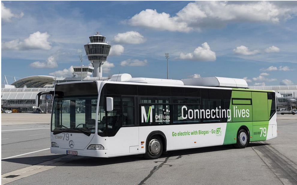
Slika 17. Autobus s pogonom na bio-metan, [69]
