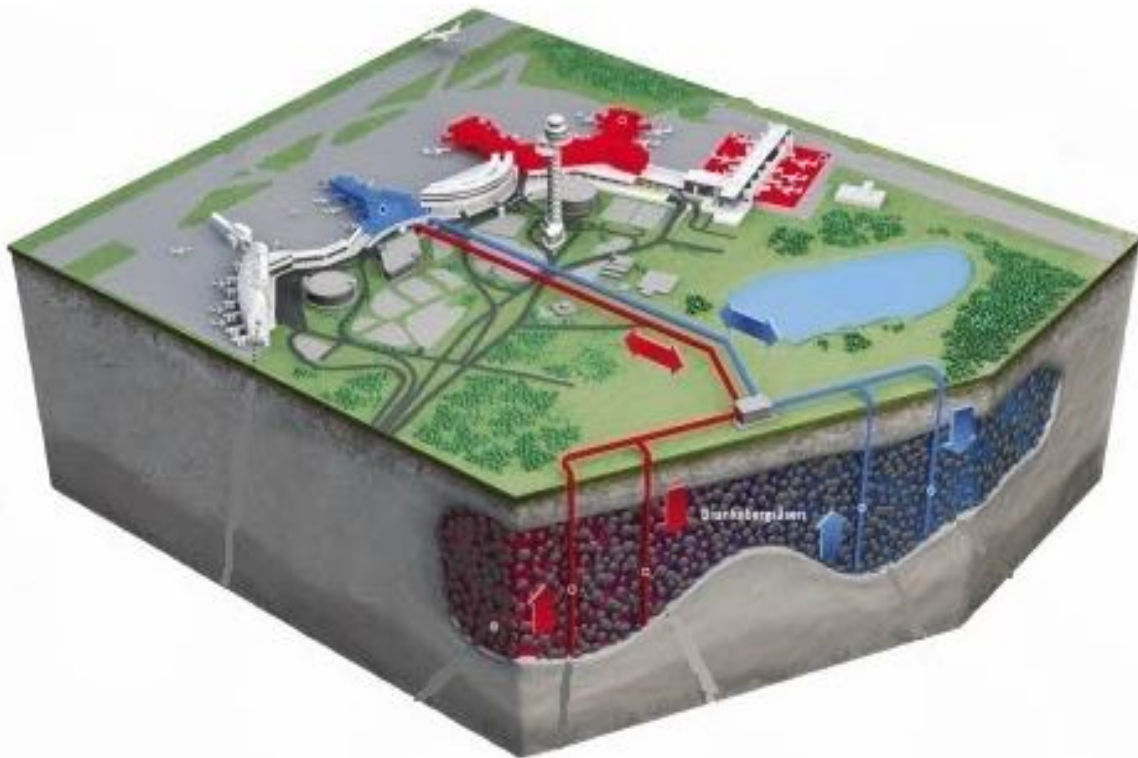
Slika 24. Sustav grijanja i hlađenja zračne luke Arlanda, [59]
