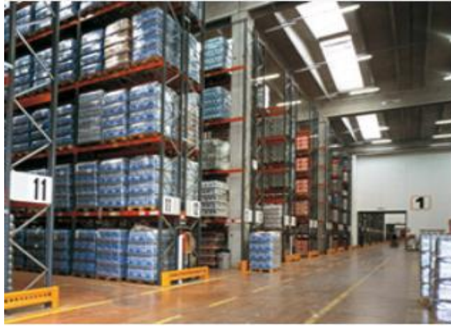
Slika 17: Prikaz jednostrukog regala
