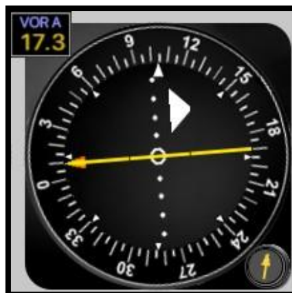
Slika 33. Očitavanje radijala pomoću HSI prikaznika
