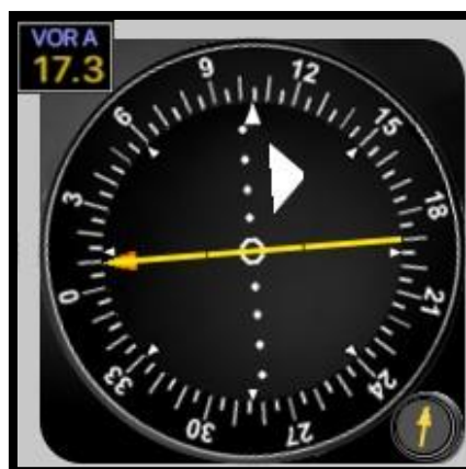
Slika 33. Očitavanje radijala pomoću HSI prikaznika
