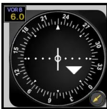
Slika 29. Očitavanje radijala pomoću CDI prikaznika
