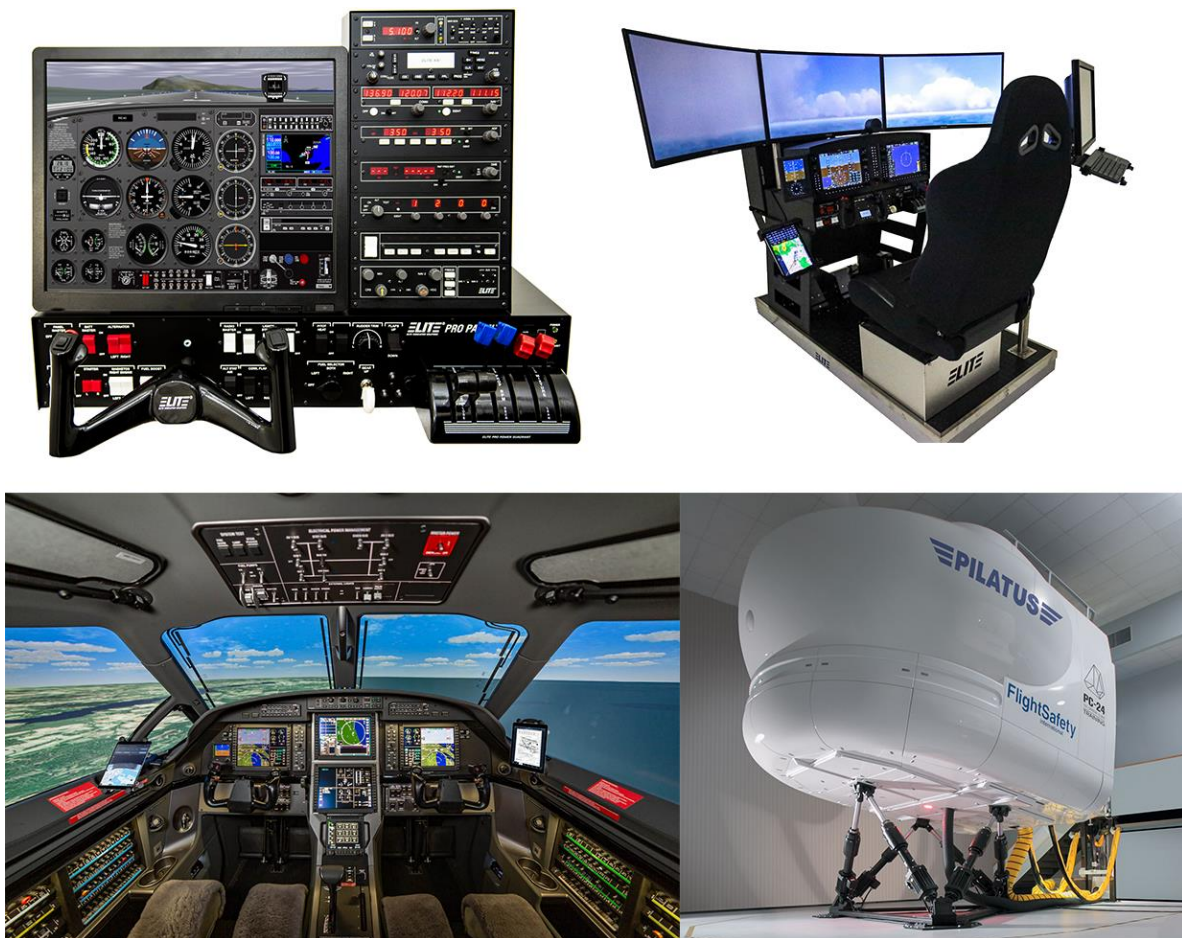
Slika 1. Primjer izgleda trenažera (poredano): BITD, FNPT, FTD, FFS [5]
