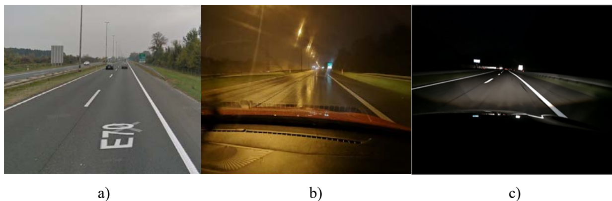
Slika 10. Dobra vidljivost oznaka na kolniku u dnevnim uvjetima (a), loša vidljivost oznaka na kolniku u noćnim uvjetima (b) i dobra vidljivost oznaka na kolniku u noćnim uvjetima (c)
