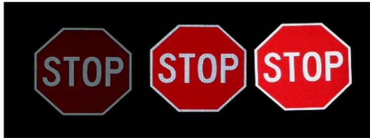
Slika 8. Prikaz prometnog znaka STOP izrađenog od retroreflektirajućeg materijala klase I, klase II i klase III
