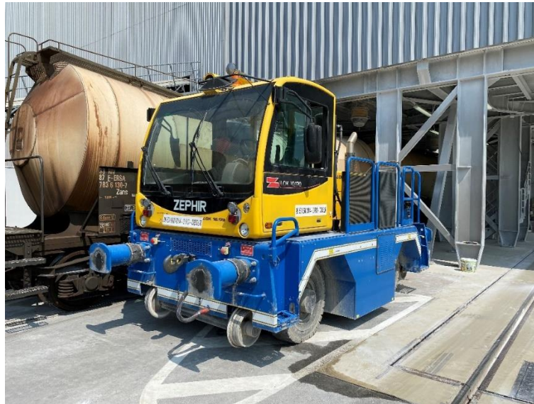
Slika 26. Manevarski traktor Zephir 10.170
