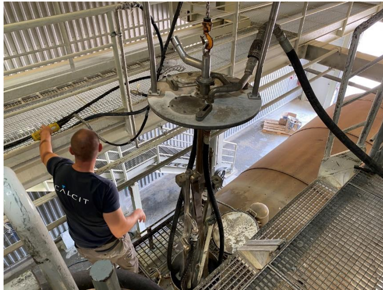
Slika 17. Naprava za pranje vagona
