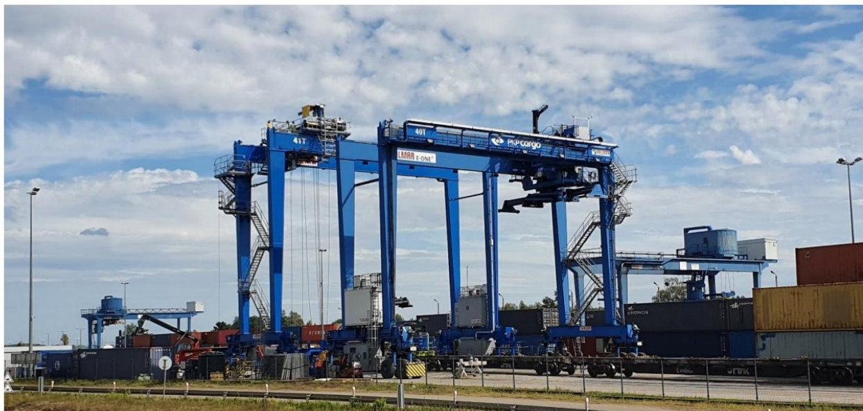
Slika 16. RTG portalni prijenosnik
