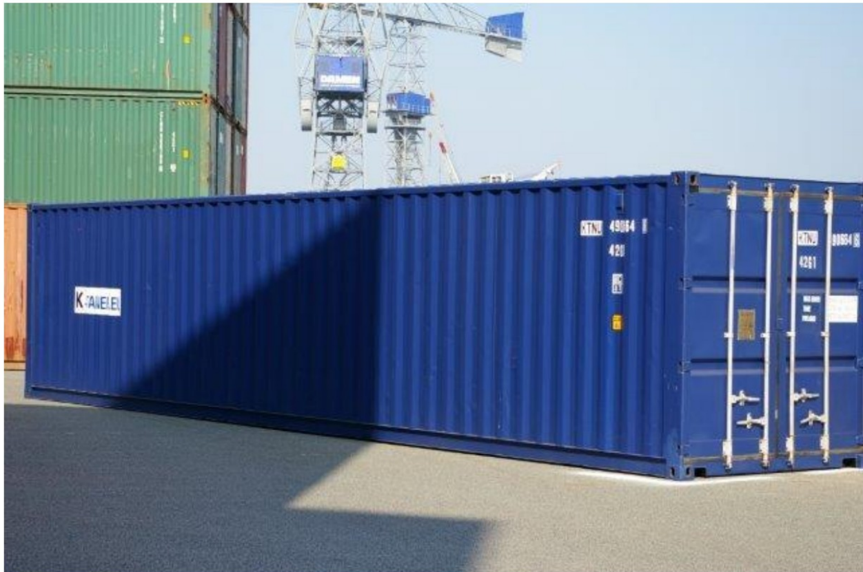
Slika 12. Univerzalni 40-stopni kontejner
